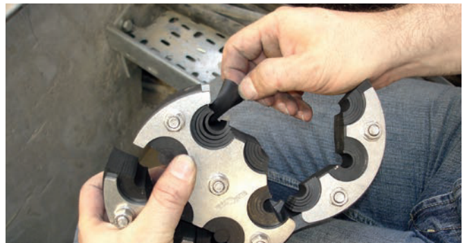
HRD 150-SG – 6/8-35 – adaptation flexible au diamètre extérieur du câble
